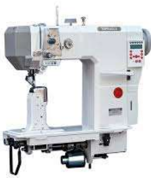
Figura 3: Máquina de coser para zapatos de poste
